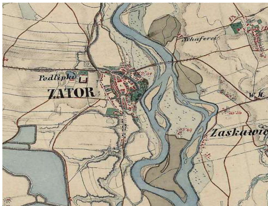
Ryc. 1. Układ wielokorytowy Skawy w Zatorze, z największym obszarem międzykorytowym. Wewnątrz obszaru opisano reper geodezyjny.
